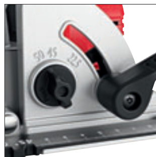
Segmento orientabile da 0° a 50° fissato su 2 punti Con preselezione dell'angolo di taglio 22,5° / 45° / 50° per una guida sicura durante l'esecuzione di tagli angolati. Previene l'inceppamento della lama nel materiale.
